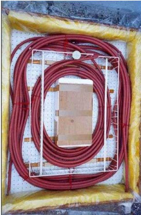
Une solide caisse en bois de 120x92x17 cm a été construite pour contenir 30 m de tuyau réticulé, utilisé normalement pour le chauffage au sol.
